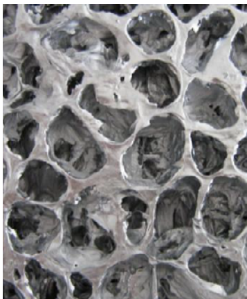
Obr. 1 Hliníková pena vyrobená metódou vstrekovania plynu do taveniny [9]
