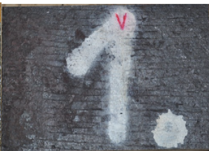
Obr. 2 Ľavý krajný výrez, brama č. 2, rýchľ. vyťahovania 1,02 m/min
