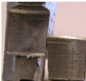
Obr.2 Výrez vzorky z odliatku (materiál odliatku - 7075 + 20%SiC)
