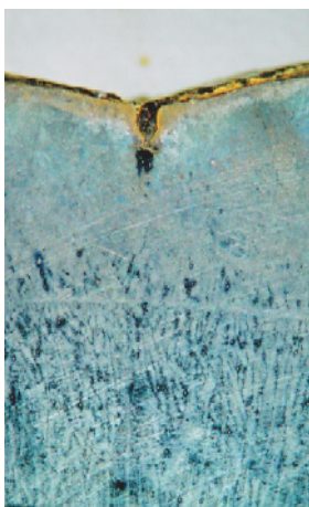
Obr.2 Priečný rez pozdĺžnou trhlinou
