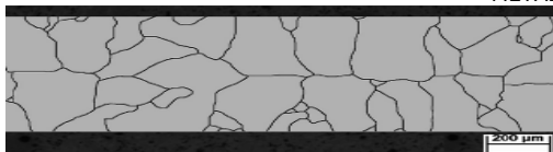
Obr.1 Kolumnárna mikroštruktúra ocele F1
