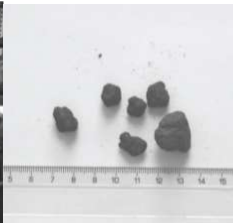
Obr. 3 Pelety z prachu [7]
