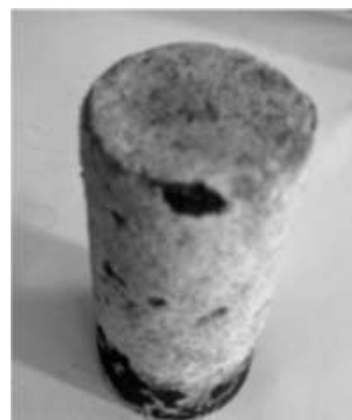
Obr. 4 Brikety z prachu z brúsenia odliatkov [8]
